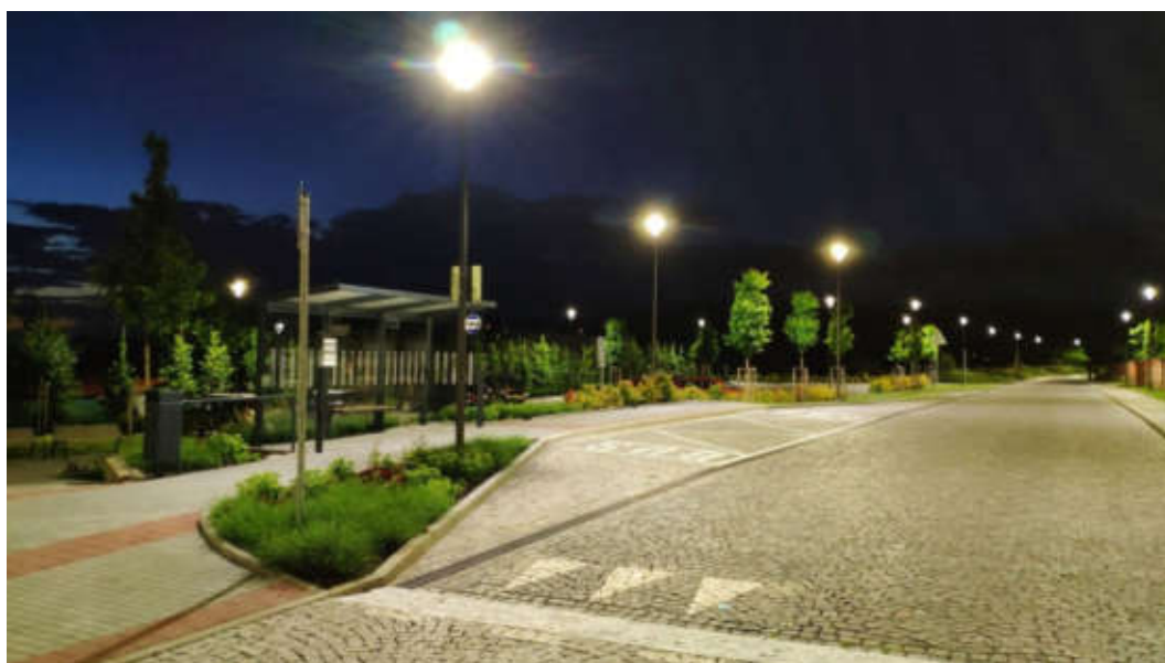
Obrázek č. 109 - Zvolená náhradní teploty chromatičnosti světelného zdroje – neutrálně bílá – přispívá k čitelnosti prostoru v místě autobusové zastávky a parkoviště
