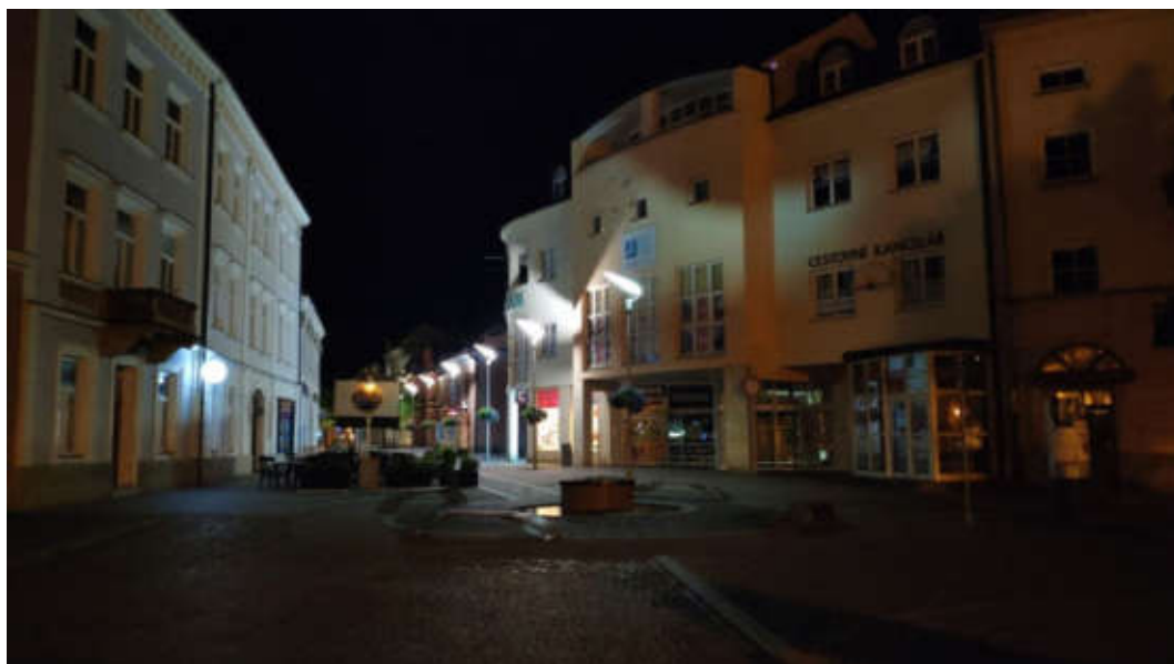
Obrázek č. 75 - Totéž osvětlení v noci. Pro pěší zóny je volba odraženého světla vhodná – nicméně zde je patrné nevhodné nastavení optiky svítidla vzhledem k velikosti odrazné desky. Svítidlo více svítí do oken sousedních objektů, než odrazem na plochu chodníku. Subjektivně je tak vnímán jako nasvětlený horní prostor ulice a nikoliv rovina chodníku
