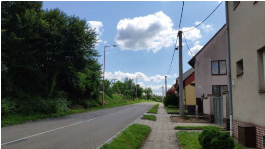
Obrázek č. 126 - Charakter VO v ulici Na Dědině – silnice III/05014 – světelné zdroje na vysokých stožárech s výložníkem
