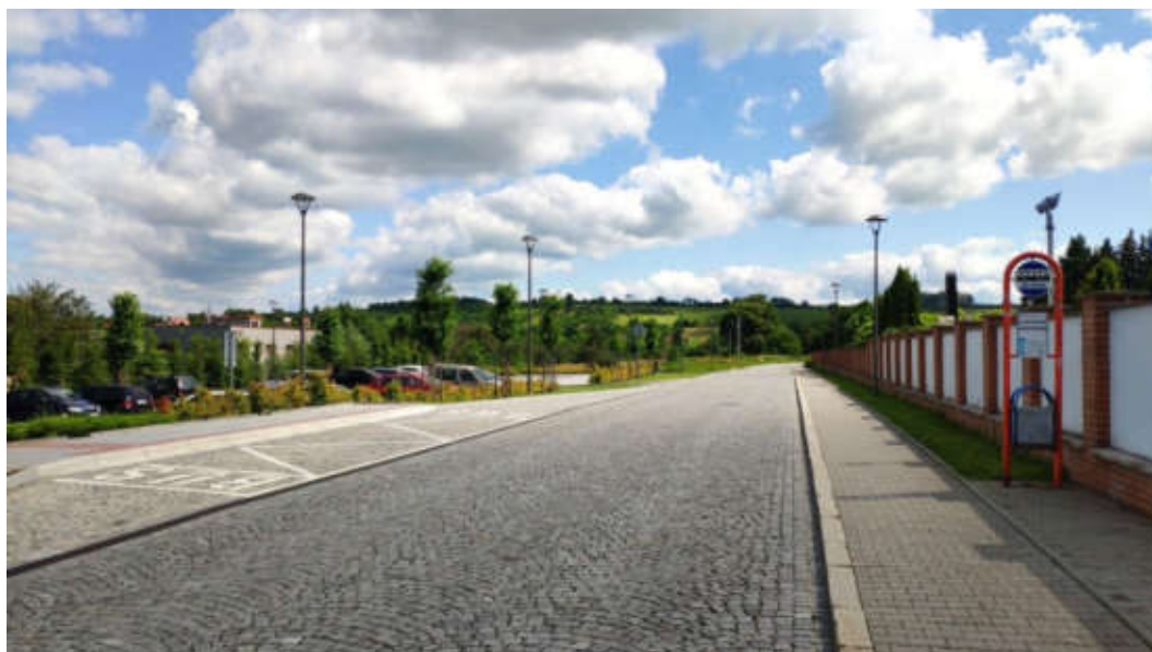
Obrázek č. 108 - Charakter VO v ulici 1. máje, v prostoru před hřbitovem s kostelem Nanebevzetí Panny Marie. Designová svítidla na kovových kónických stožárech. Výška stožárů přiměřená charakteru lokality
