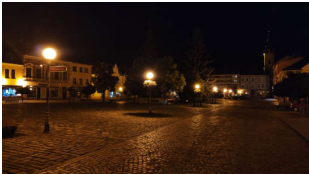
Obrázek č. 56 - Noční pohled na Mariánském náměstí – jako nedostatek je vnímána příliš malá výška stožárů svítidel v ploše náměstí, nepřiměřená velkorysosti prostoru. Patrný je zcela nedostatečný světelný akcent dominanty – věže kostela Zvěstování Panny Marie – v noční scéně náměstí se vůbec neuplatňuje
