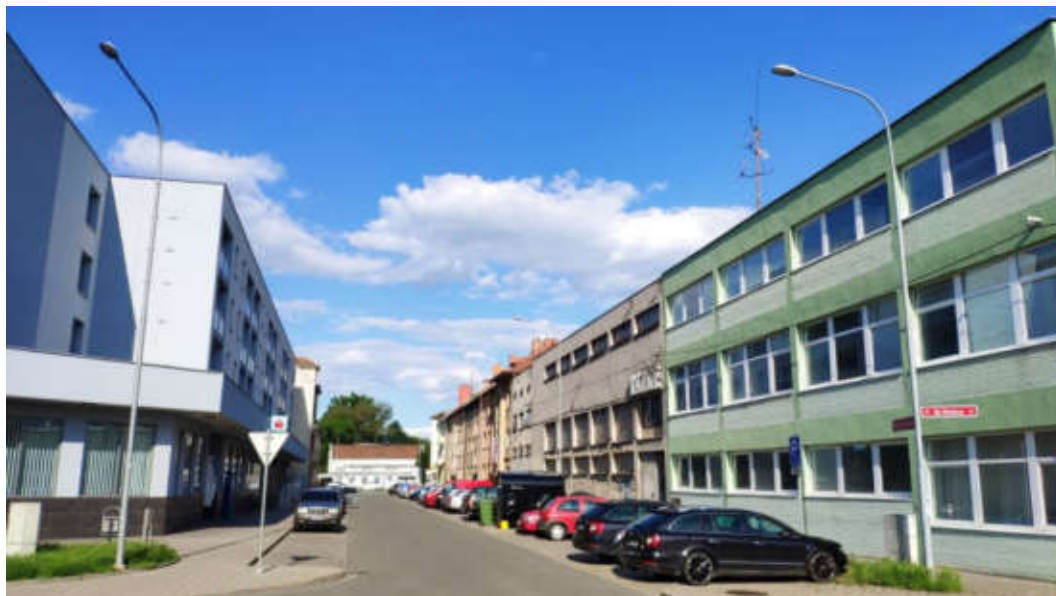
Obrázek č. 87 - Charakter VO v Dvořákově ulici - světelné zdroje na vysokých stožárech s výložníkem. V ulicích mimo základní komunikační systém města by bylo vhodné snížit výšky svítidel, pokud to prostorové podmínky v ulici umožňují
