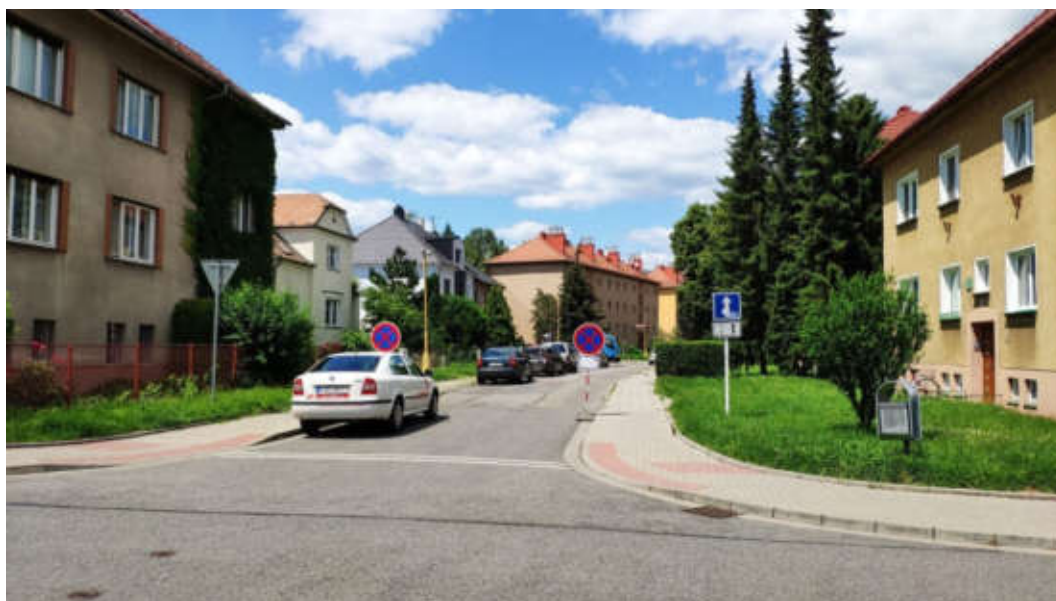
Obrázek č. 94 - Charakter VO na sídlišti Mojmir I v ulici Jana Žižky - svítidla na odstupňovaných stožárech, s patící, svítidlo bez důrazu na design
