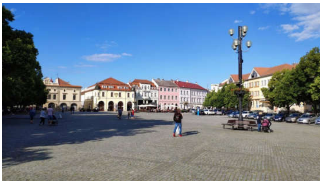
Obrázek č. 68 - Charakter VO v ploše Masarykova náměstí – sestava kulových svítidel na standardním odstupňovaném válcovém stožáru s patičí
